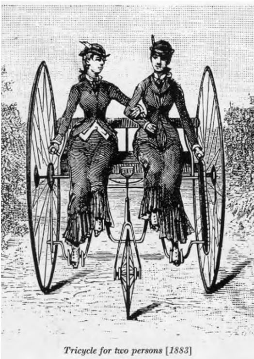
図 31 2 人乗り 3 輪型自転車(1883)—回転ペダル・チェーン駆動 [出典]Leonard de Vries(1971), Victorian Inventions ,p11
