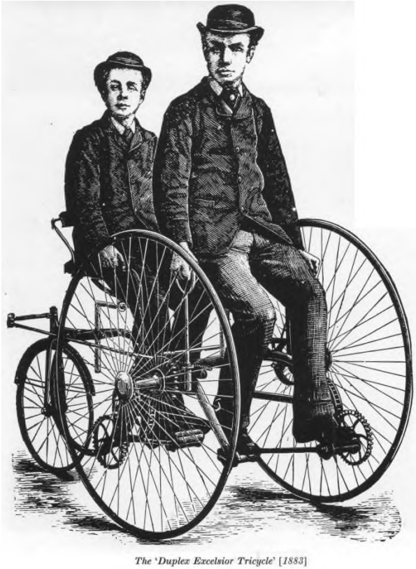
図 29 2 人乗り 3 輪型自転車(1883)—回転ペダル・連結ギア駆動 [出典]Leonard de Vries(1971), Victorian Inventions ,p12
