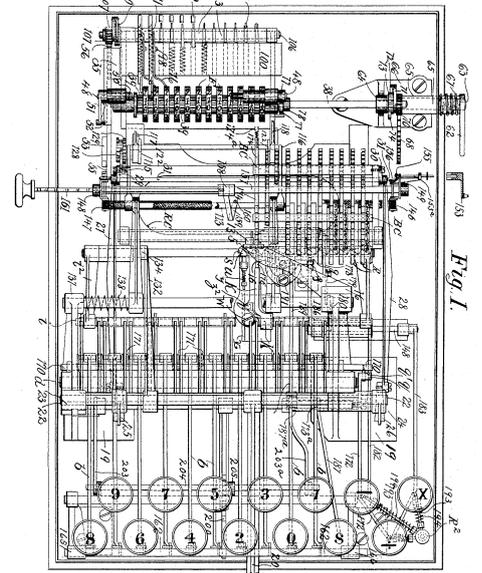
(2)と(3)のマシでは偶数が上段に(2)と(3)のマシでは偶数が上段に奇数が下段に配置されているのに対して、(1)と(4)のマシでは奇数が上段に偶数が下段に配置されている。
