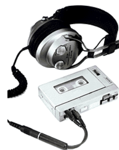
「プレスマン」を改造して、大きなヘッドホンをつけた試作機
