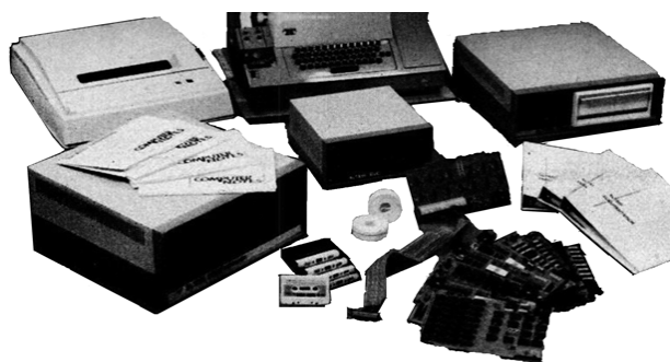
図5 Popular Mechanics 1976年9月号に掲載されたAltair8800と組み合わせ利用が想定されていた典型的なシステム・コンポーネント
