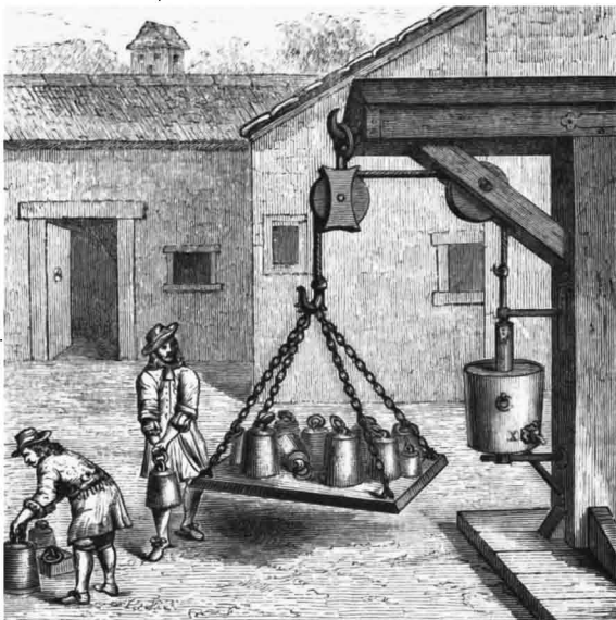
図3. 重錘を吊り上げるのに適用されたフォン・ゲーリックの空気ポンプ、1654年。彼の Experimenta Nova.....Magdeburgica , 1673 より。
